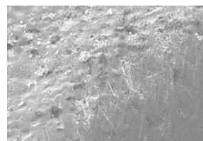
Surface émaillée non traitée et traitée avec Resin PoliStrip 15µm agrandissement SeM 2000x
